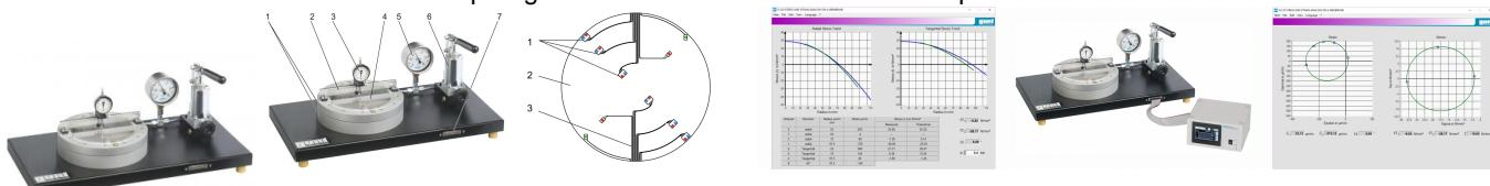
Pour l'analyse expérimentale des contraintes, on utilise des jauge de contrainte pour déterminer les contraintes présentes dans les composants et les constructions.
