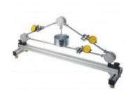
Le FL 111 représente un treillis idéal. Dans le système plan, les barres sont soumises uniquement à la compression et à la traction.
