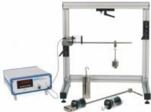
Livré avec 3 barres équipées de jauge de déformation: traction, torsion et flexion
