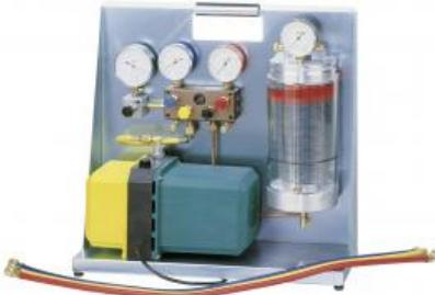
Le kit de maintenance ET 910.13 permet de remplir et dévacuer des installations frigorifiques et de réaliser des opérations de maintenance et de dépannage.
