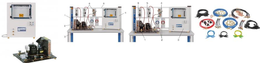
Il est possible de réaliser des expérimentations pratiques pour le fonctionnement d'une installation frigorifique par le maniement de circuits frigorifiques à compression configurés de différentes manières.
