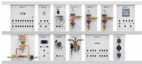
Le ET 910.11 permet la réalisation, avec les ET 910, ET 910.10, ET 910.05 et le kit d'accessoires ET 910.12, d'essais complémentaires en génie frigorifique.
