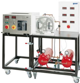
1 compresseur, 2 poulie de courroie, 3 réservoir d'aspiration, 4 soupape de purge avec silencieux, 5 soupape de sécurité, 6 réservoir sous pression, 7 pressostat, 8 électrovanne, 9 armoire de commande avec affichages numérique
