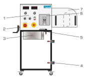
1 élément d'affichage et de commande, 2 broche du dispositif de tension de la courroie trapézoïdale, 3 résistance de charge, 4 terminal à genouillère, 5 levier de blocage du dispositif de tension, 6 trappe de service transparente, 7 site de projection de la courroie trapézoïdale
