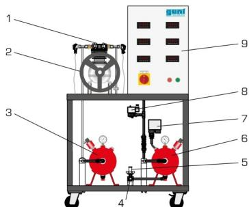
1 compresseur, 2 poulie de courroie, 3 réservoir d'aspiration,
