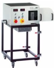
1 élément d'affichage et de commande, 2 broche du dispositif de tension de la courroie trapézoïdale, 3 résistance de charge, 4 terminal à genouillère, 5 levier de blocage du dispositif de tension, 6 trappe de service transparente, 7 site de projection de la courroie trapézoïdale
