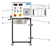
1 élément d'affichage et de commande, 2 broche du dispositif de tension de la courroie trapézoïdale, 3 résistance de charge, 4 terminal à genouillère, 5 levier de blocage du dispositif de tension, 6 trappe de service transparente, 7 site de projection de la courroie trapézoïdale
