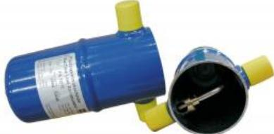
Les modèles en coupe représentent les éléments d'usage en technique du froid tels que des compresseurs, des vannes, des déshydrateurs et des séparateurs de liquide.
