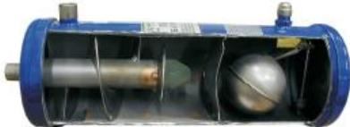
Les modèles en coupe représentés les éléments d'usage en technique du froid tels que des compresseurs, des vannes, des déshydrateurs et des séparateurs de liquide.
