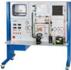
Les installations frigorifiques à deux niveaux de compression sont utilisées dans le cas où des températures particulièrement basses doivent être atteintes.
