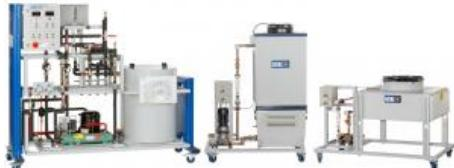
Les accumulateurs de glace sont utilisés en génie frigorifique, afin de couvrir un besoin de refroidissement supplémentaire (pointe de charge).
