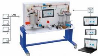
**Production de froid à l'aide d'énergie thermique, avec interface PC USB et logiciel inclus**
