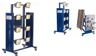
La source de lumière artificielle HL 313.01 permet d'effectuer des tests sur l'énergie solaire indépendamment de la lumière naturelle.
