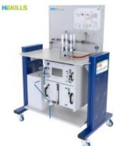
**ET 280 Electrolyseur pour production d'hydrogène 500 NL/h, 35 bar max (AEM)**
