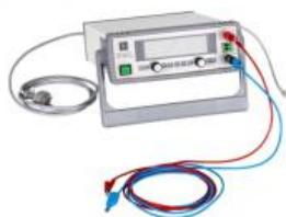
L'ET 255.01 avec l'ET 255 permet de simuler les caractéristiques de courant et de tension des modules photovoltaïques.
