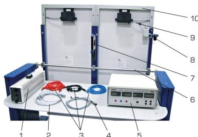
1 résistance à curseur, 2 câble d'alimentation, 3 jeu de câbles pour le montage en série et en parallèle, 4 câble de mesure, 5 amplificateur de mesure, 6 aise réleasable, 7 gradomètre, 8 enregistreur de l'éclairement, 9 capteur de température, 10 modules solaires
