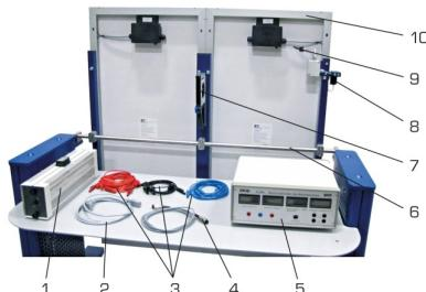
1 résistance à curseur, 2 câble d'alimentation, 3 jeu de câbles pour le montage en série et en parallèle, 4 câble de mesure, 5 amplificateur de mesure, 6 aise rétractable, 7 gradomètre, 8 enregistreur de l'éclairement, 9 capteur de température, 10 modules solaires
