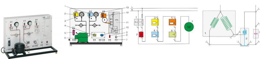
La circuiterie des composants électriques pour le démarrage et le fonctionnement de compresseurs d'agent réfrigérant est une tâche typique du génie frigorifique.
