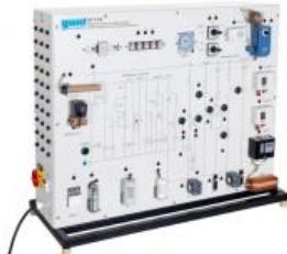
Des connaissances larges sont nécessaires pour identifier les pannes dans les installations frigorifiques. Outre la structure et la fonction des différents composants électriques, la lecture des schémas de connexion fait partie de ces connaissances.
