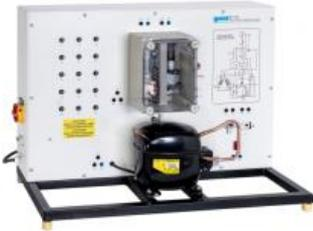
Des connaissances larges sont nécessaires pour identifier les pannes dans les installations frigorifiques. Outre la structure et la fonction des différents composants électriques, la lecture des schémas de connexion fait partie de ces connaissances.
