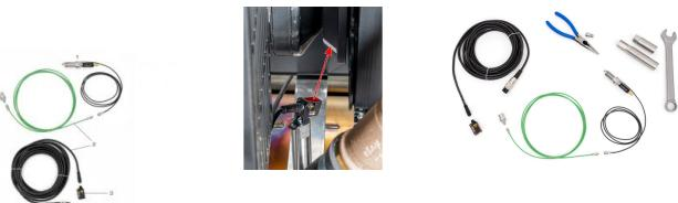
Pour les essais avec indication de pression dans le cylindre sur le moteur de test CT 400.01, la bougie normale est remplacée par une bougie instrumentée.
