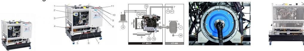
Le moteur CT 400.01, associé à l'unité de charge CT 400, forme un banc dessai pour moteurs complets.
