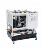
Le moteur CT 400.01, associé à lunité de charge CT 400, forme un banc dessai pour moteurs complet.
