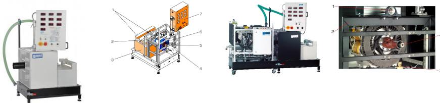
Ce banc dessai permet de mesurer la puissance des moteurs à combustion interne jusqu'à une puissance de 75kW.
