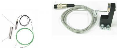
Pour les essais avec indication de pression dans le cylindre sur le moteur de test CT 150, la bougie normale est remplacée par une bougie instrumentée.
