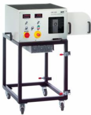
1 élément d'affichage et de commande, 2 broche de dispositif de tension de la courroie trapézoïdale, 3 résistance de charge, 4 fermeture à genouillère, 5 bride de montage du dispositif de tension, 6 trappe de service transparente, 7 tôle de protection de la courroie trapézoïdale
