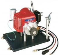
En combinaison avec le banc dessai CT 159 et le dispositif de freinage et entraînement HM 365, le moteur essence deux temps simple convient parfaitement à l'enseignement des principes de base du fonctionnement et de la technique de mesure sur moteurs.
