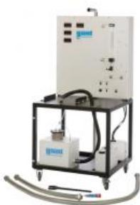
Ce banc dessai permet de mesurer la puissance des moteurs à combustion interne jusqu'à une puissance de 3kW. Le banc dessai complet se compose de trois éléments principaux: CT 159 pour recevoir le moteur et comme dispositif de commande, le dispositif de freinage et entraînement universel HM 365 comme unité de charge, ainsi qu'un moteur au choix: moteur diesel quatre temps (CT 151), moteur essence deux temps (CT 153), ainsi que moteur essence quatre temps (CT 150).
