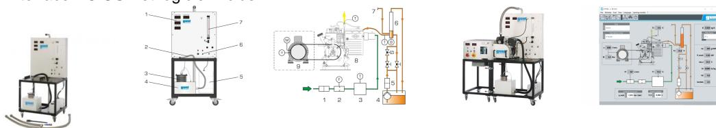
Ce banc dessai permet de mesurer la puissance des moteurs à combustion interne jusqu'à une puissance de 3kW. Le banc dessai complet se compose de trois éléments principaux: CT 159 pour recevoir le moteur et comme dispositif de commande, le dispositif de freinage et entraînement universel HM 365 comme unité de charge, ainsi qu'un moteur au choix: moteur diesel quatre temps (CT 151), moteur essence deux temps (CT 153), ainsi que moteur essence quatre temps (CT 150).
