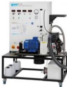
Ce banc dessai permet de mesurer la puissance des moteurs à combustion interne jusqu'à une puissance de 7,5kW. Le banc dessai complet se compose de deux éléments principaux: CT 110 comme unité de commande et de charge, et un moteur au choix: moteur essence quatre temps (CT 100.20), moteur essence deux temps (CT 100.21), ainsi que deux moteurs diesel quatre temps (CT 100.22, à injection directe, refroidi par air; CT 100.23, à injection indirecte, refroidi par eau).
