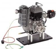
En combinaison avec le banc dessai CT 110, qui renferme une unité de freinage et de entraînement, le moteur essence deux temps convient parfaitement à l'enseignement des principes de base du fonctionnement et de la technique de mesure sur moteurs.
