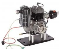
En combinaison avec le banc d'essai CT 110, qui renferme une unité de freinage et de entraînement, le moteur essence deux temps convient parfaitement à l'enseignement des principes de base du fonctionnement et de la technique de mesure sur moteurs.
