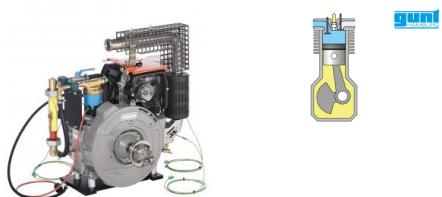
En combinaison avec le banc dessai CT 110, qui renferme une unité de freinage et d'entraînement, le moteur diesel quatre temps convient parfaitement à l'enseignement des principes de base du fonctionnement et de la technique de mesure sur moteurs.
