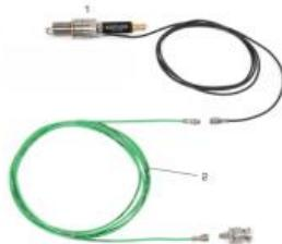
Pour les essais avec indication de pression dans le cylindre sur le moteur de test CT 100.21, la bougie normale est remplacée par une bougie instrumentée.
