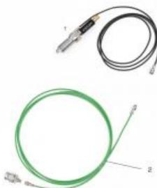
Pour les essais avec indication de pression dans le cylindre sur le moteur de test CT 100.20, la bougie normale est remplacée par une bougie instrumentée.
