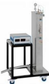
La détermination des pertes thermiques des gaz déchappement est nécessaire pour effectuer le bilan énergétique des moteurs à combustion interne.
