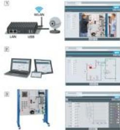
Le logiciel Web Access Software permet de connecter l'appareil dessai à la Web Access Box GU 100. D'une part, le logiciel Web Access assure la configuration nécessaire de la Web Access Box et prend en charge l'échange de données entre la Web Access Box et l'appareil dessai. D'autre part, il constitue le lien avec l'utilisateur via l'interface logicielle dans le navigateur web.
