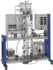
Les réacteurs Airlift sont des réacteurs submergés alimentés en énergie par gazage.
