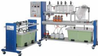
Le CE 586 démontre l'élimination des matières dissoutes par précipitation et flocculation suivies d'une sédimentation.
