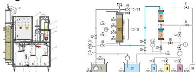
La filtration en profondeur à laide de filtres à sable et l'échange d'ions sont des opérations unitaires importantes du traitement de l'eau.
