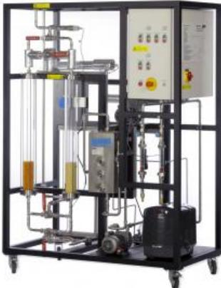
Le CE 540 permet d'expliquer clairement les bases théoriques complexes des processus d'adsorption à l'aide de dessais. Un compresseur aspire l'air ambiant.
