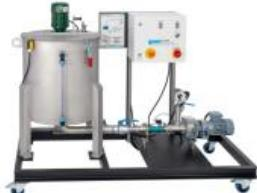
Le CE 285 alimente les bancs dessai de filtration en suspension de diatomite et deau (recommandée).
