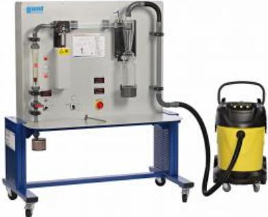
La séparation préliminaire des matières solides dans les gaz constitue une application des cyclones gaz. Cyclones gaz ne possèdent aucune pièce en mouvement et ne nécessitent par conséquent que très peu de entretien.
