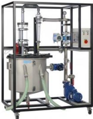
**CE 225 Banc de séparation de matière solide dans les liquides par Hydrocyclone (Réf. 083.22500)**
