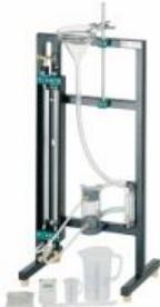
Le CE 116 permet d'observer et détudier les processus de filtration en profondeur et de filtration sur gâteau. La suspension (eau et diatomite comme matière solide) coule de l'entonnoir de remplissage dans l'élément filtrant, où les matières solides sont retenues.
