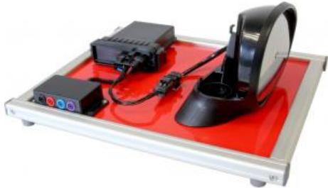
Maquette LIN BUS avec un rétroviseur automobile.
