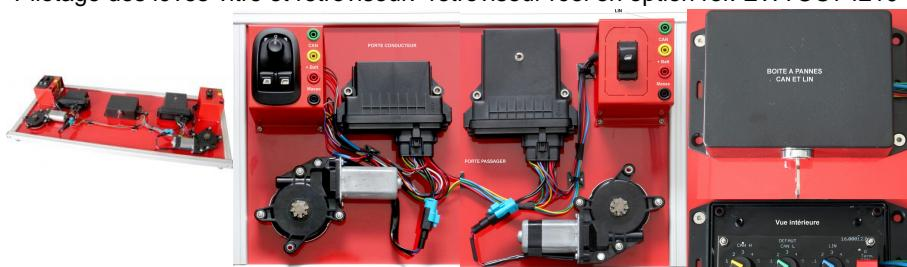
Maquette avec la partie commande des lèves-vitre et en option retroviseur d'un véhicule.
