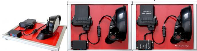
Maquette LIN BUS avec un rétroviseur automobile.
