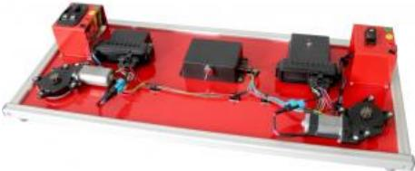
Maquette avec la partie commande des lève-vitres et en option rétroviseur d'un véhicule.
