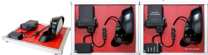
Maquette LIN BUS avec un rétroviseur automobile.
