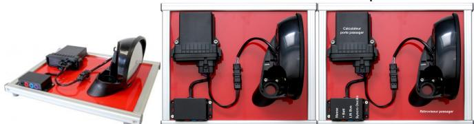
Maquette LIN BUS avec un rétroviseur automobile.
