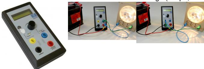
Permet de commander: lampe, GMV, papillon motorisé, électrovanne, injecteurs, bobine d'allumage, vannes RCO, compteur de vitesse, compte tours, jauge ....
