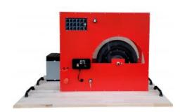
Maquette avec les éléments liés à la motorisation d'un cyclo électrique à moteur bruschless, pour la découverte d'une motorisation 100% électrique.
