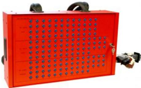
Les faisceaux sont soudés dans le boîtier, plus de problème de connectique.
