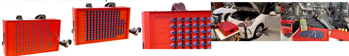
Les faisceaux sont soudés dans le boîtier, plus de problème de connectique.
