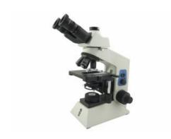
Ce microscope trinoculaire a des objectifs à haute résolution et deux grand champ (WF) oculaires avec l'optique du régime.
