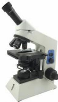
Ce microscope monoculaire a des objectifs de haute définition et un large champ ( WF ) avec optique oculaire du régime.
