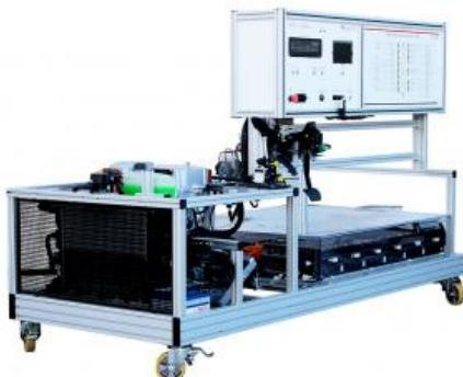
**Banc VE basé sur un véhicule Renault Zoé avec simulation de 10 pannes**
