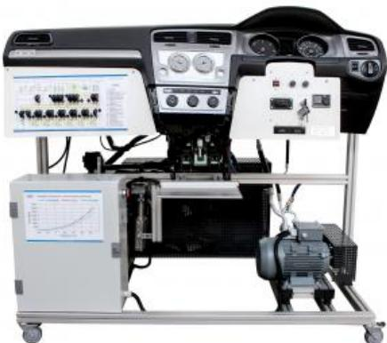
Simulateur de climatisation et de régulation climatique à deux zones avec gaz R 1234yf
