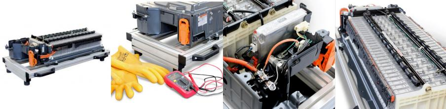
Ce support de formation automobile est un pack de batteries haute tension d'origine Toyota Prius.
