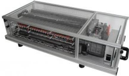
Trou d'accès dans le pléxi glace de protection pour la mesure de tension aux bornes de chaque cellule
