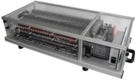
Trou d'accès dans le pléxi glace de protection pour la mesure de tension aux bornes de chaque cellule
