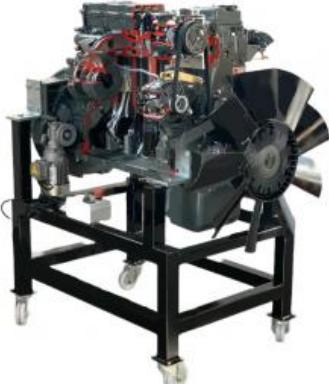
**Moteur diesel 6 cylindres « IVECO » complet en coupe, avec entraînement électrique**
