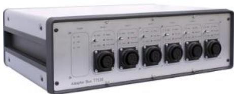
La tâche du boîtier adaptateur avec électronique est de convertir un signal TTL numérique en signal de puissance (24VDC / 1A) pour piloter le moteur de la vanne de régulation, de générer un signal numérique pour les limites droite et gauche de la vanne et pour mapper la sortie du potentiomètre sur une plage de tension de -10V ... + 10V.
