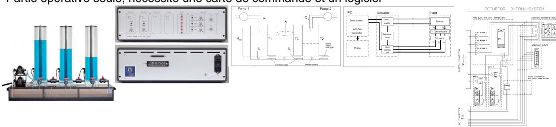
Le système à trois réservoirs se compose de trois cylindres en plexiglas interconnectés en série par des vannes à commande manuelle.
